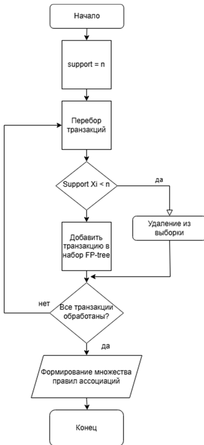
Рис. 3. Алгоритм фильтрации правил ассоциаций Fig. 3. Association rules filtering algorithm
