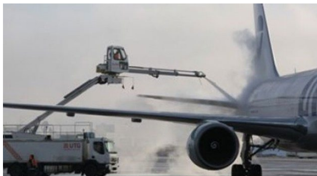
Рис. 1. Машина Vestergaard Elephant Beta для противообледенительной обработки ВС
