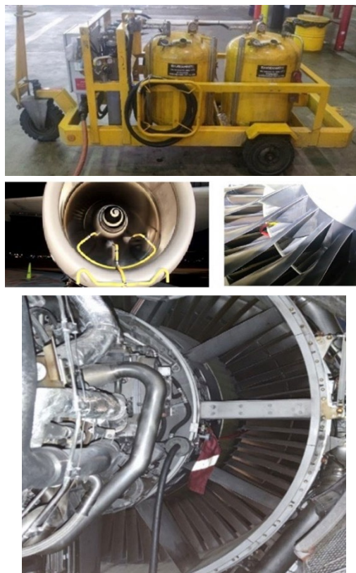
Рис. 2. Оборудование для промывки проточной части двигателя
