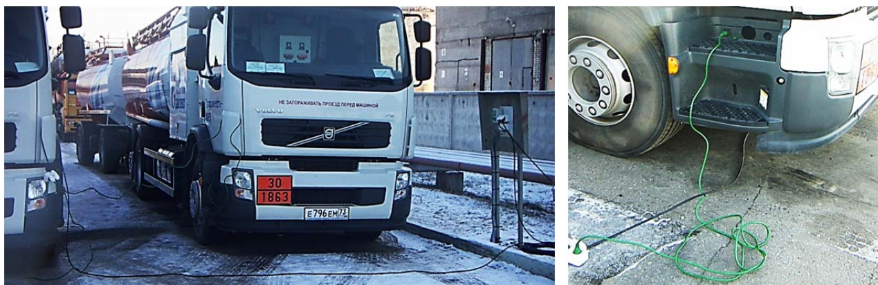
Рис. 10. Подогрев ТЗА внешним источником питания Fig. 10. Heating of the refueling tanker using an external power source
