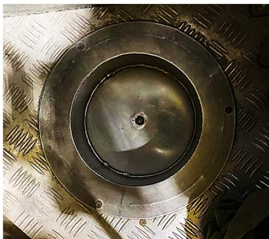
Рис. 8. Доработанный стакан ННЗ Fig. 8. Modified docking point of the underwing refueling nozzle tip
