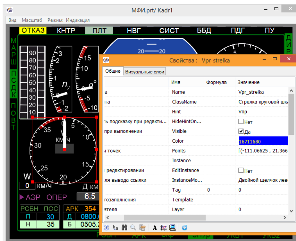
Рис. 5. Свойства элемента «стрелка приборной скорости» в программе SimInTech Fig. 5. Properties of the “indicated airspeed arrow” element in the SimInTech application
