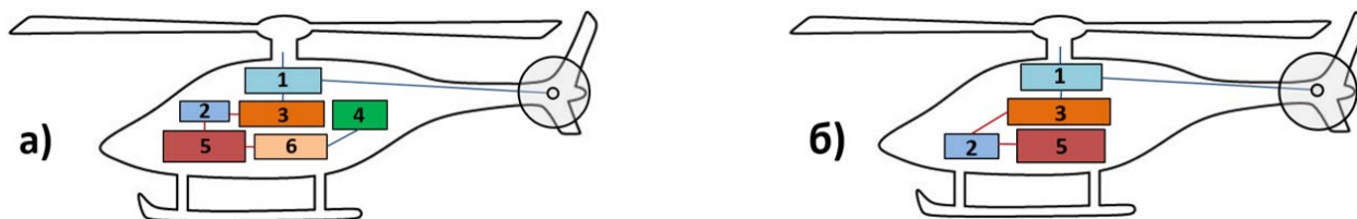
Рис. 1. Основные элементы СУ одновинтового вертолета с гибридной (а) и полностью электрической (б) силовой установкой
