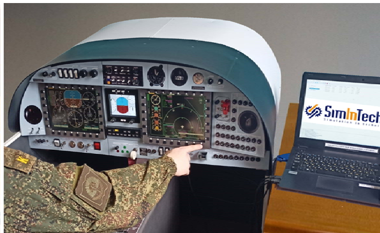
Рис. 12. Работа обучающегося с имитатором МФИ: а – в аудитории; б – на интерактивном макете кабины экипажа самолета ДА-42Т
