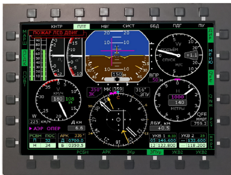
Рис. 4. Имитаторы основного (а) и резервного (б) МФИ Fig. 4. Simulators of the primary (a) and backup (б) MFI
