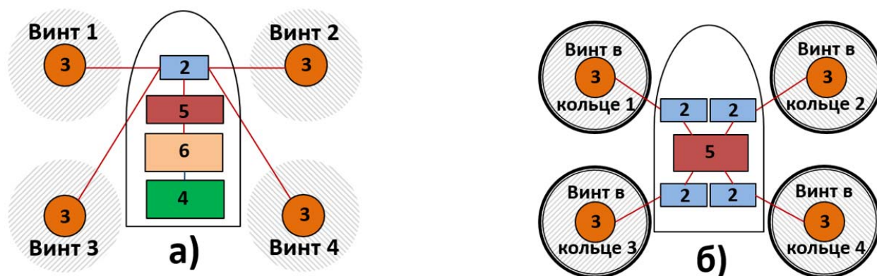
Рис. 2. Основные элементы СУ квадрокоптера: а – с открытыми винтами с гибридной силовой установкой; б – с винтами в кольце с полностью электрической силовой установкой
