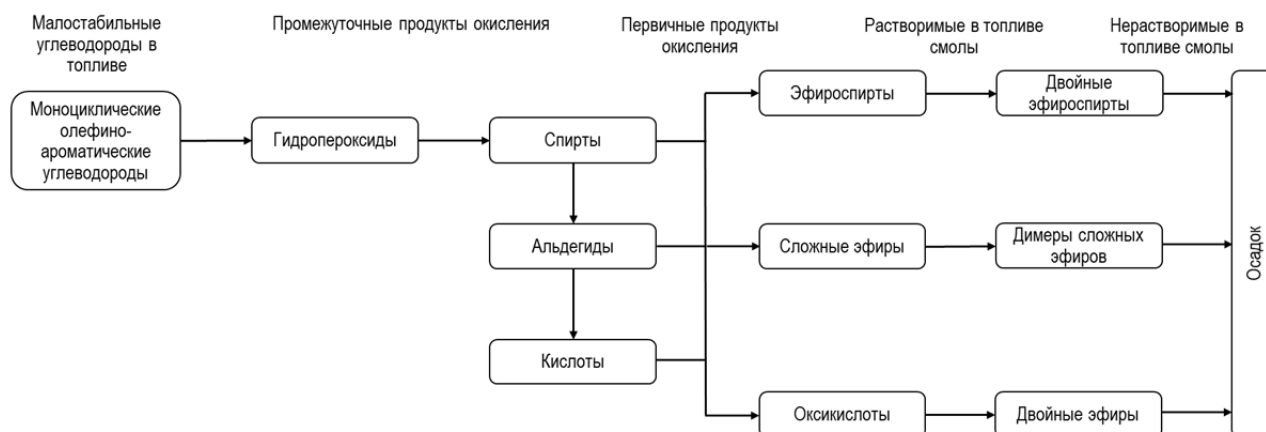
Рис. 9. Механизм осадкообразования в АТ при хранении Fig. 9. The sediment formation mechanism in aviation fuel during storage
