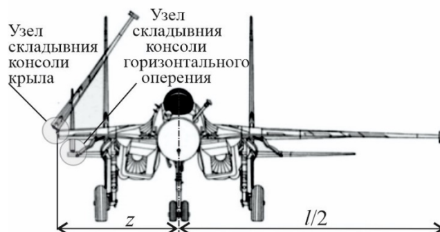
Рис. 4. Су-33 с узлами складывания консолей крыла и горизонтального оперения Fig. 4. Su-33 with the half-wing and the horizontal stabilizer folding assembly units
