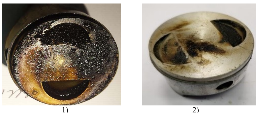
Рис. 5. Вид поршня бензинового двигателя Saito GI-36 после эксплуатации на масле: 1 – Новойл-ДД (20 часов); 2 – Motul Kart Grand Prix 2T (50 часов)
