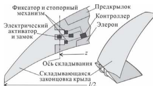
Рис. 6. Схема системы складывания законцовки крыла 3
