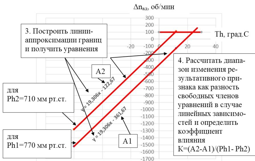
Рис. 2. Получение аналитического описания зависимости изменения частоты вращения ротора ВД от атмосферных условий (давления P_H и температуры T_H ) при работе двигателя на земле на взлетном режиме
