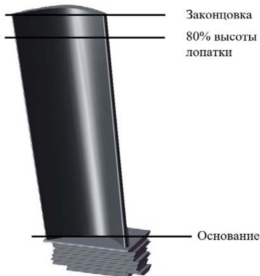
Рис. 1. Схема сечений вырезки образцов из лопатки для металлографического исследования Fig. 1. Scheme of cross sections of samples cutoff from a blade for metallographic examination
