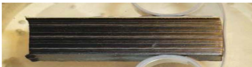
Рис. 1. Разрез 33-слойного композита с окрашенной поверхностью Fig. 1. Section of the 33-layer composite with a painted surface
