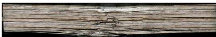
Металлографическое изображение сечения при ударе Ø20 мм/50 Дж
