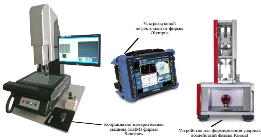
Рис. 2. Оборудование для проведения эксперимента Fig. 2. Equipment to carry out an experiment
