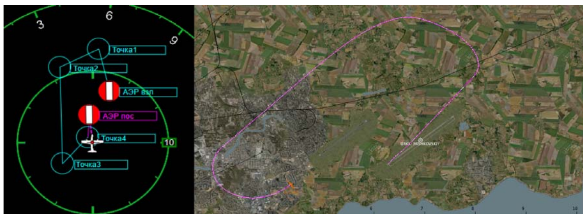
Рис. 5. Маршрут на кадре НВГ при полете на аэродром посадки и траектория полета по этому маршруту на карте в авиасимуляторе X-Plane
