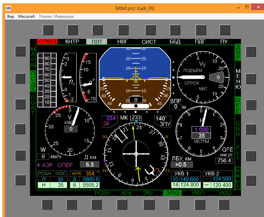
Рис. 3. Кадр ПЛТ (пилотаж), разработанный в программе SimInTech Fig. 3. PLT (piloting) frame developed in the SimInTech program
