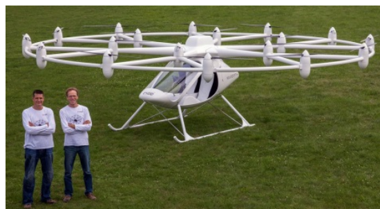
Рис. 4. Восемнадцативинтовой мультикоптер Fig. 4. Eighteen-rotor multi-rotor design
