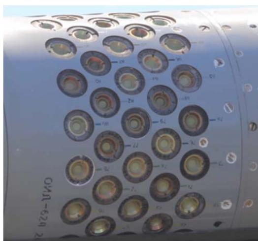
Рис. 2. Микродвигатели импульсной двигательной установки
