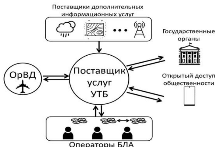
**Рис. 1.** Схематическая архитектура системы УТБ, демонстрирующая взаимодействия между различными агентами, вовлеченными в процесс управления полетами БЛА
