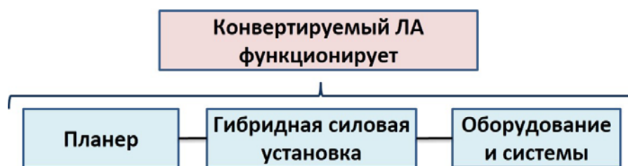
Рис. 6. Структурная схема верхнего уровня для конвертируемого ЛА Fig. 6. Structural top-level diagram for a convertible aircraft
