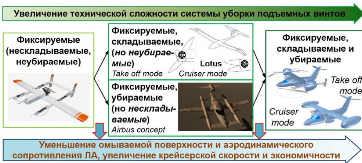
Рис. 2. Конструктивные решения для подъемных ВМГ конвертируемых ЛА Fig. 2. Functional solutions for lifting rotor groups of convertible aircraft
