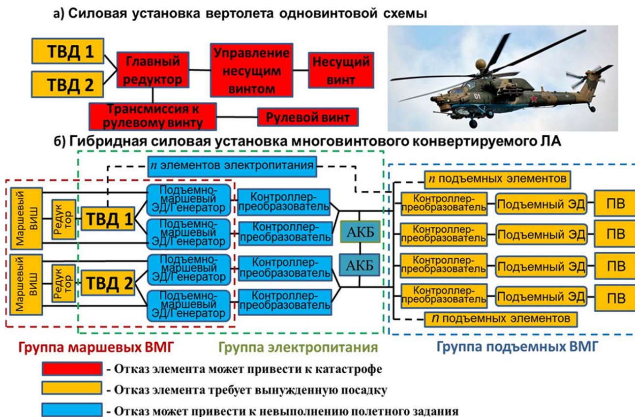
Рис. 7. Принципиальная схема силовой установки: а) для одновинтового вертолета; б) для многовинтового конвертируемого ЛА с ГСУ
