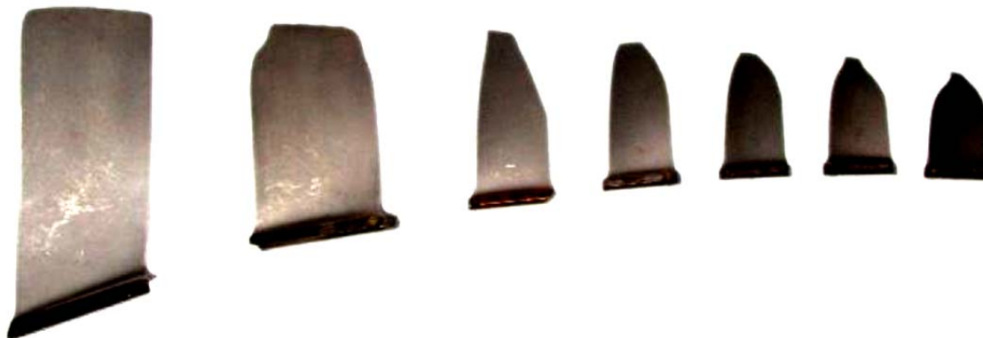
Рис. 3. Характер предельного износа рабочих лопаток по ступеням со 2-й по 8-ю (наработка 128 ч) [22]
