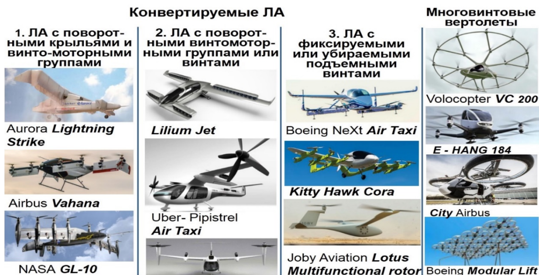
Рис.1. Классификация концепций ЛА вертикального взлета и посадки с электрической или гибридной силовой установкой Fig. 1. Classification of VTOL aircraft concepts with electric or hybrid power plant
