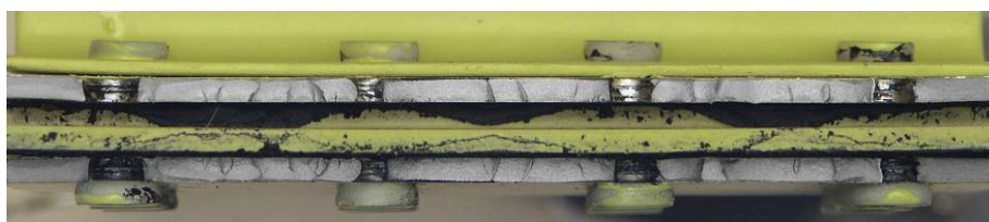
Рис. 7. Разрушение по галтельному переходу, например, образец 8.100 № 1, крепёж – заклёпки ЗУГА Fig. 7. Destruction of the fillet, for example, sample 8.100 No. 1, fasteners - rivets ZUGA
