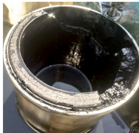
Рис. 3. Центрифуга ТЦМ-25 после 100 часов работы двигателя Fig. 3. TCM-25 centrifuge after 100 hours of engine operation
