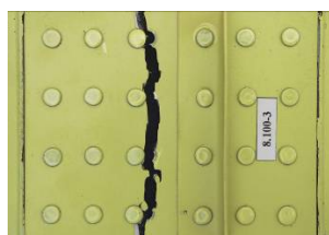
Рис. 7. Разрушение по галтельному переходу, например, образец 8.100 № 1, крепёж – заклёпки ЗУГА Fig. 7. Destruction of the fillet, for example, sample 8.100 No. 1, fasteners - rivets ZUGA
