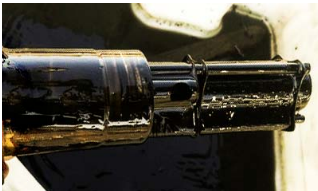
Рис. 2. Фильтр МФМ-25 после 1,5 часов работы двигателя Fig. 2. MFM-25 filter after 1.5 hours of engine operation
