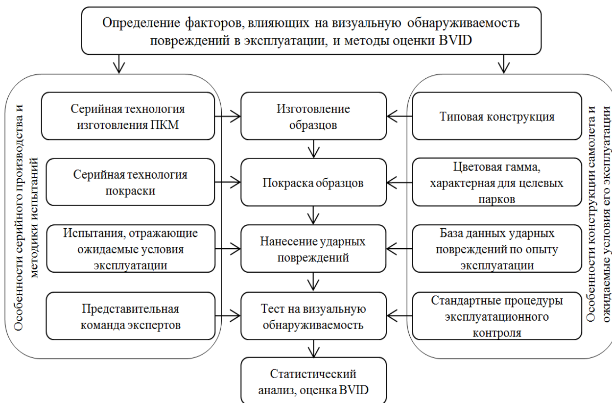
Рис. 1. Общая схема эксперимента по определению BVID Fig. 1. The general scheme of BVID experimental evaluation
