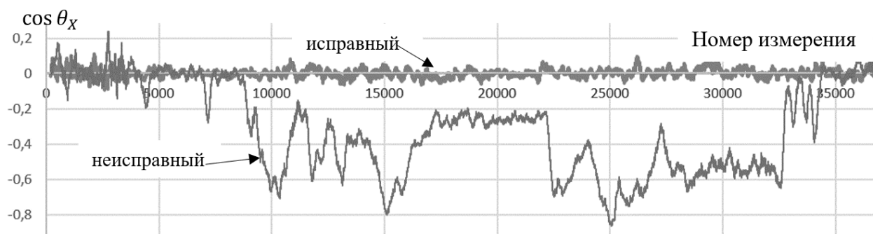
Рис. 7. Сравнение направляющего конуса угла вектора вибрации по оси X для исправного и неисправного состояния объекта вибромониторинга Fig. 7. Comparison of a director cone of an angle of vibration vector on axis X for operational and failed condition of a vibromonitoring item
