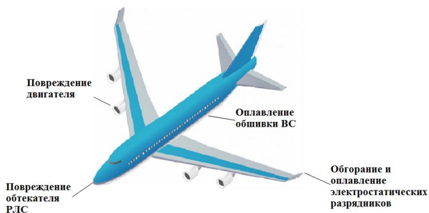
Рис. 8. Места повреждений воздушных судов в результате попадания электрических разрядов Fig. 8. Aircraft damage places as a result of contact with electrical discharges
