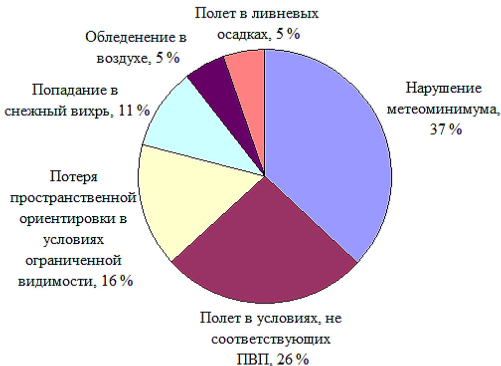
Рис. 4. Распределение причин авиационных происшествий, связанных с неблагоприятными внешними условиями, для вертолетов в 2008–2014 гг.
