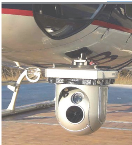
Рис. 3. Размещение камеры системы класса EVS на гиростабилизированной платформе Fig. 3. Camera placement of EVS class system on the gyro-stabilized platform
