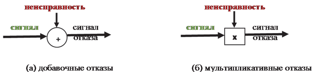
Рис. 2. Виды математического моделирования отказов органов управления самолетом Fig. 2. Aircraft control surface faults mathematical modeling types
