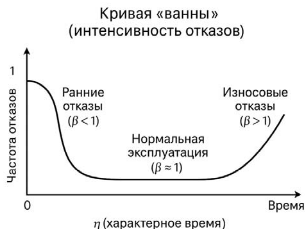
Рис. 3. Кривая интенсивности отказов Fig. 3. The failure rate curve
