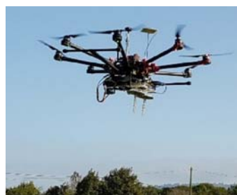
Рис. 8. Окткоптер Spreading Wings S1000 с Pulson P410 UWB на борту Fig. 8. Octocopter Spreading Wings S1000 with Pulson P410 UWB on board
