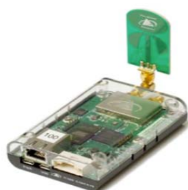
Рис. 9. Сверхширокополосный (UWB) радиоприемопередатчик, работающий на модуле PulsON 440 (P440) Fig. 9. Ultra Wideband (UWB) radio transceiver operating PulsON 440 (P440) module
