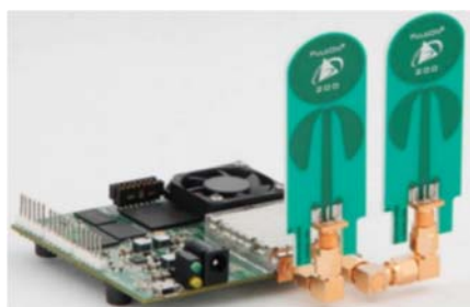
Рис. 7. Радиолокационный модуль Pulson P410 UWB Fig. 7. Radar module Pulson P410 UWB
