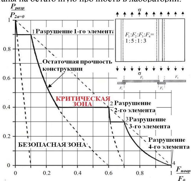
Рис. 5. Остаточная прочность составных конструкций, поврежденных обширными усталостными трещинами (WFD)
