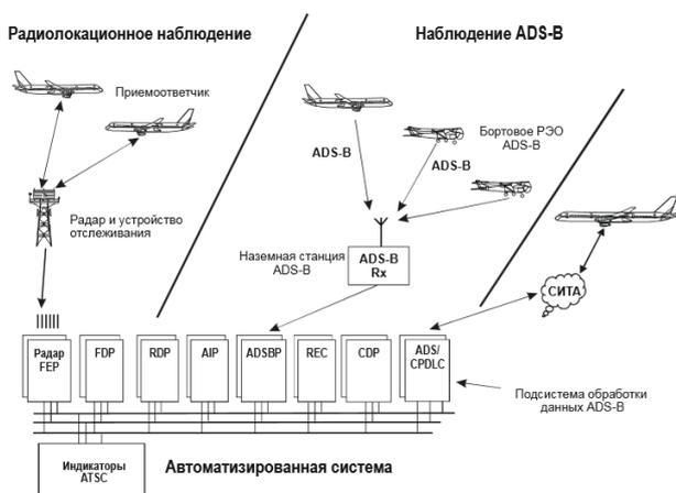
**Рис. 1.** Типичная архитектура системы наблюдения в целях ОВД
