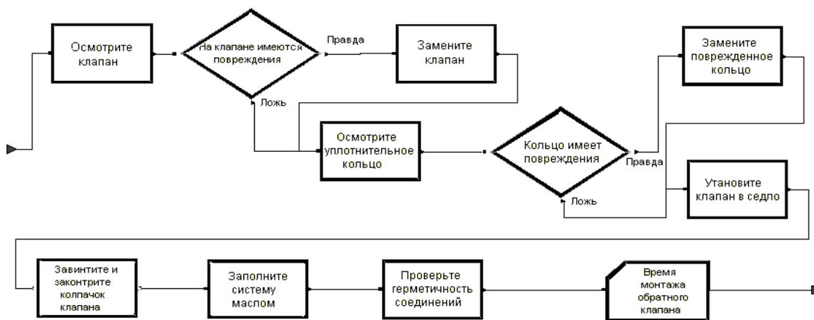
Рис. 3. Имитационная модель процесса технического обслуживания обратного клапана маслонасоса
