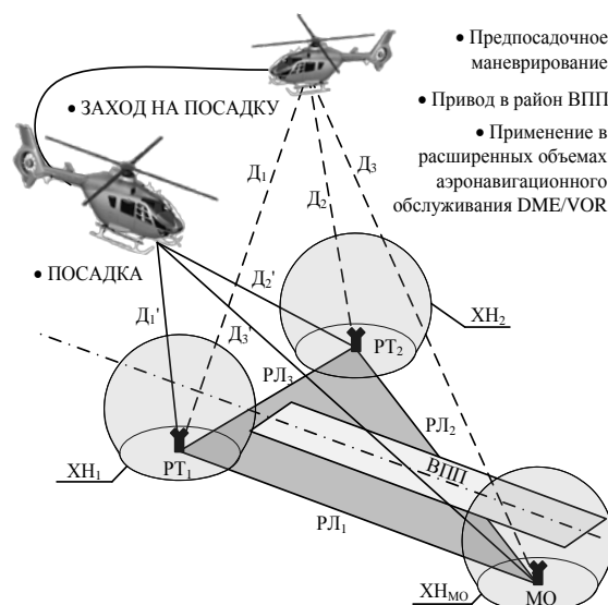
Рис. 5. Принцип действия МПСП
