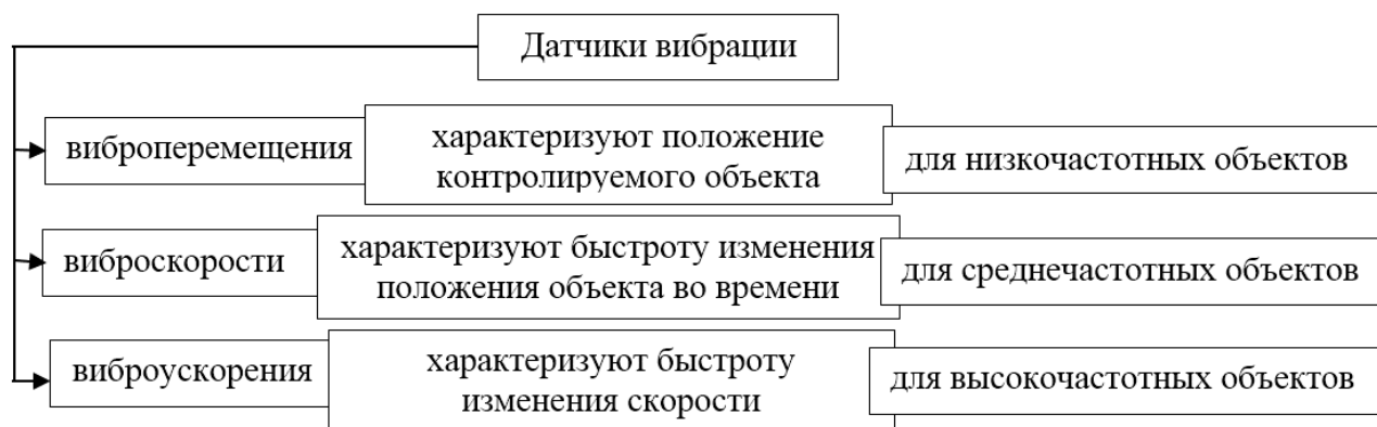
Рис. 1. Классификация и области применения датчиков вибрации
