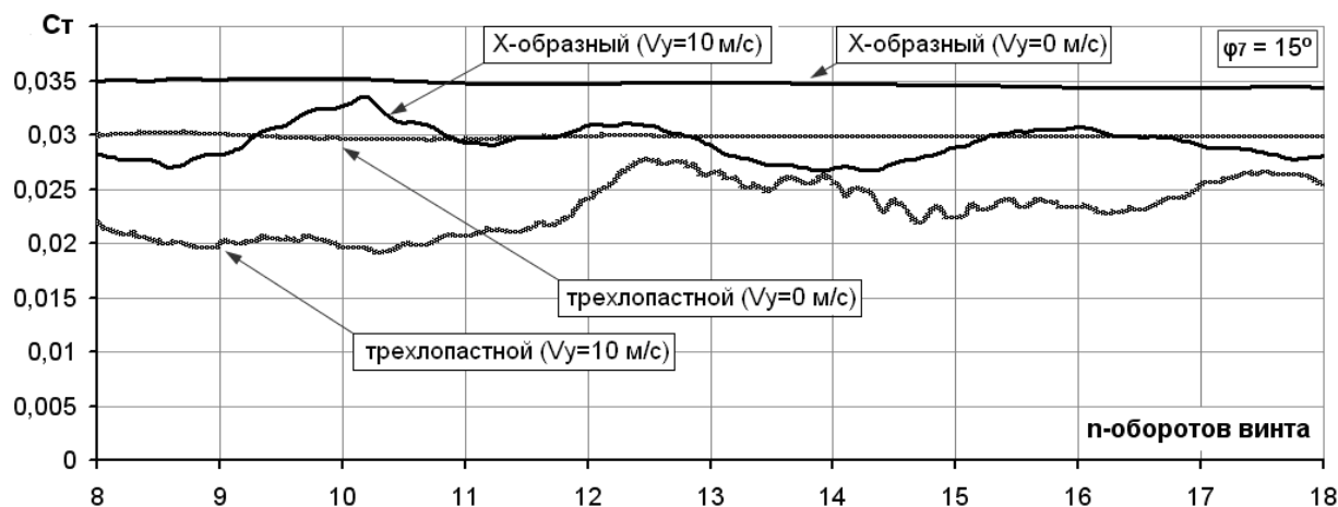
Рис. 4. Расчетные зависимости коэффициента тяги РВ на режимах висения ( \varphi_{7\text{РВ}} = 15^\circ ) и режиме вертикального снижения ( \alpha_{\text{Н}} = 90^\circ ; V_y = 10 м/с; \varphi_{7\text{РВ}} = 15^\circ ) от числа оборотов винта n
