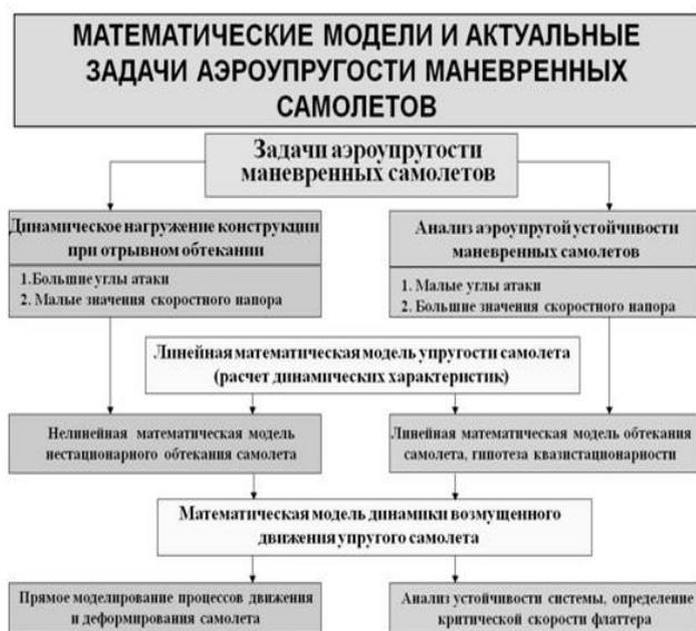
Рис. 1. Задачи аэроупругости и методы их решения
