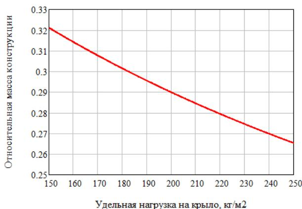
**Рис. 3.** Зависимость относительной массы конструкции высотного БЛА от удельной нагрузки на крыло
