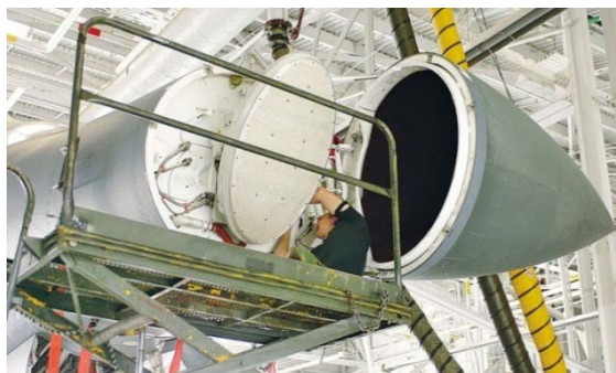
Рис. 4. Фазированная антенная решетка БРЛС AN/APQ-164 в носовой части дальнего бомбардировщика B-1B 30МК
