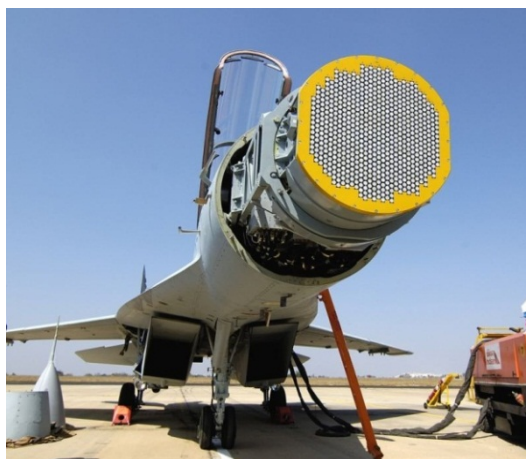
Рис. 6. АФАР БРЛС «Жук-А» на истребителе МиГ-35 со снятым носовым обтекателем
