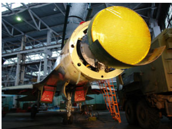
Рис. 7. ФАР РЛСУ «Ирбис-Э» на летающей лаборатории Су-30МК
