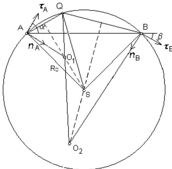
Рис. 2. Нахождение центров  $O_1$  и  $O_2$  по заданной точке  $Q$  на вспомогательной окружности
