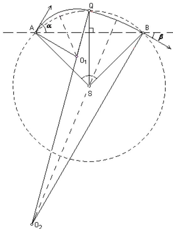
**Рис. 6.** Построение сопряженных дуг с минимальным скачком кривизны. Углы наклона касательных  $\alpha = 60^\circ$ ,  $\beta = 30^\circ$ . S – центр вспомогательной окружности, SQ – биссектриса угла ASB
