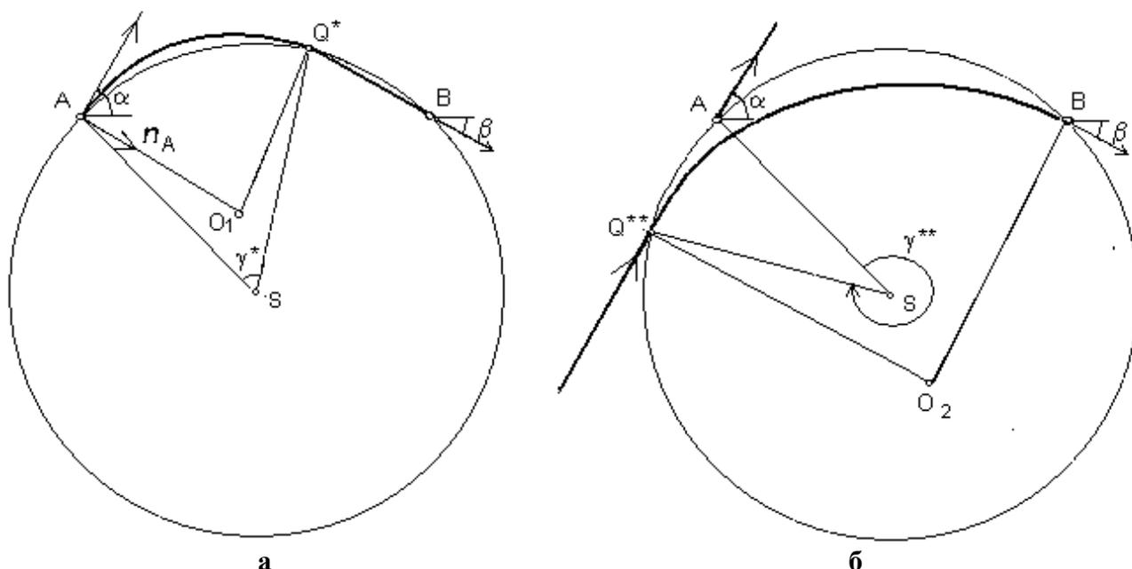
Рис. 3. Примеры построения дуг для случаев  $\gamma = 2\beta$  (а) и  $\gamma = 2\pi - \alpha + \beta$  (б)
