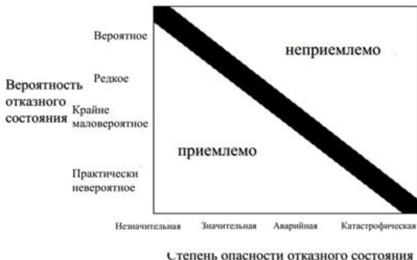
Рис. 4. Зависимость между средней вероятностью возникновения отказных состояний на час полета и их степенью опасности
