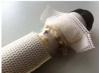
Рис. 2. Разобранный фильтроэлемент
