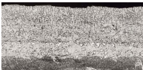
Рис. 3. Микроструктура комбинированного покрытия
