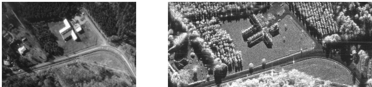
Рис. 11. Изображение одного и того же участка местности: слева – полученное с помощью оптической съемки; справа – РЛИ, синтезированное ИФРСА RAMSES в K_u -диапазоне
