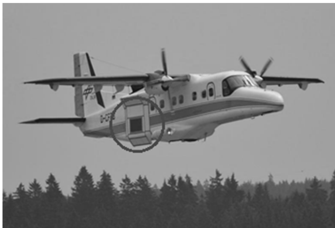
Рис. 7. DO228-212 с установленной ИФРСА F-SAR (кругом обозначена платформа для крепления антенн)
