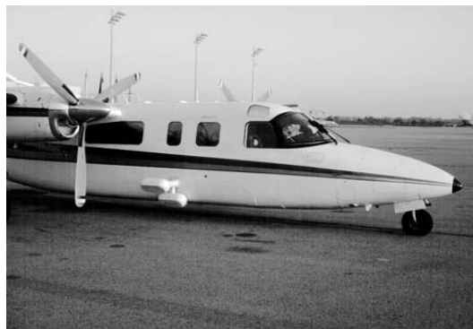
Рис. 9. Turbine Commander с установленной ИФРСА AeS-1
