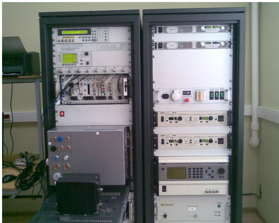
Рис. 1. Внешний вид НАСКД-200-8/17: на переднем плане – демонтированный блок бортового авиационного оборудования, за ним - адаптер
