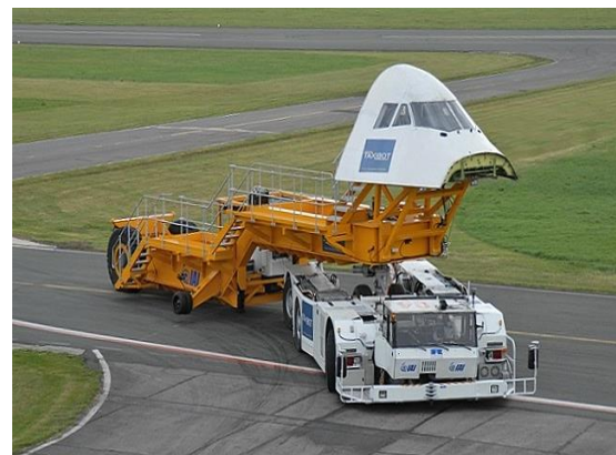
Рис. 2. Автоматический тягач Taxibot
