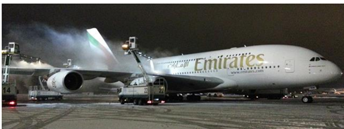
Рис. 3. Противообледенительная обработка самолета Airbus A-380
