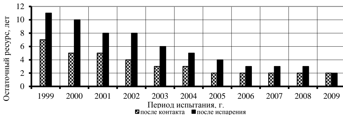
Рис. 4. Изменение остаточного ресурса резиновых уплотнительных колец после хранения в составе ЗИП
