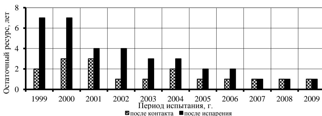
Рис. 3. Изменение остаточного ресурса резиновых уплотнительных колец после эксплуатации
