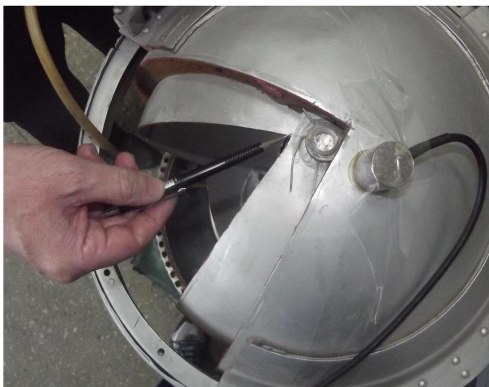
Рис. 4. Имитация сигналов АЭ в верхней части
