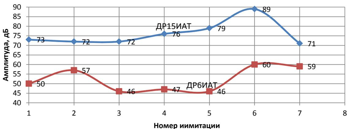
**Рис. 5.** Графики амплитуды для ДР15ИАТ и ДР6ИАТ при имитации сигналов АЭ в нижней части внутренней емкости
