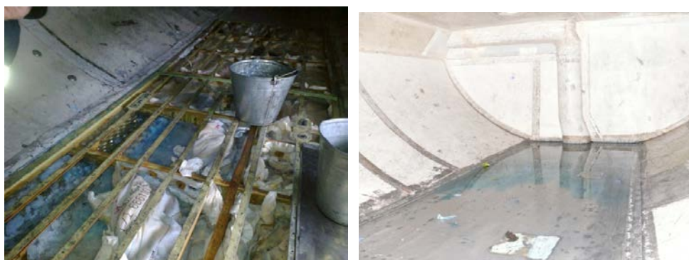
Рис. 5. Лед и вода в заднем багажнике
