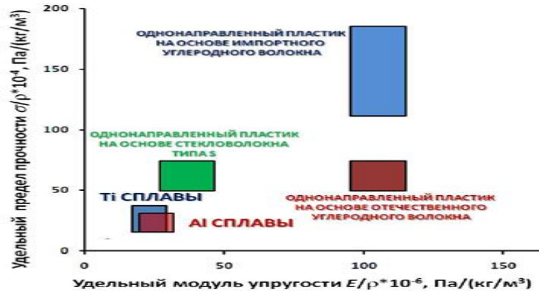
Рис. 3. Сравнение удельной прочности ( \sigma/\rho ), модуля упругости ( E/\rho ) углеродных КМ как зарубежного, так и отечественного производства с традиционными конструкционными материалами (Ti, Al, металлические сплавы)
