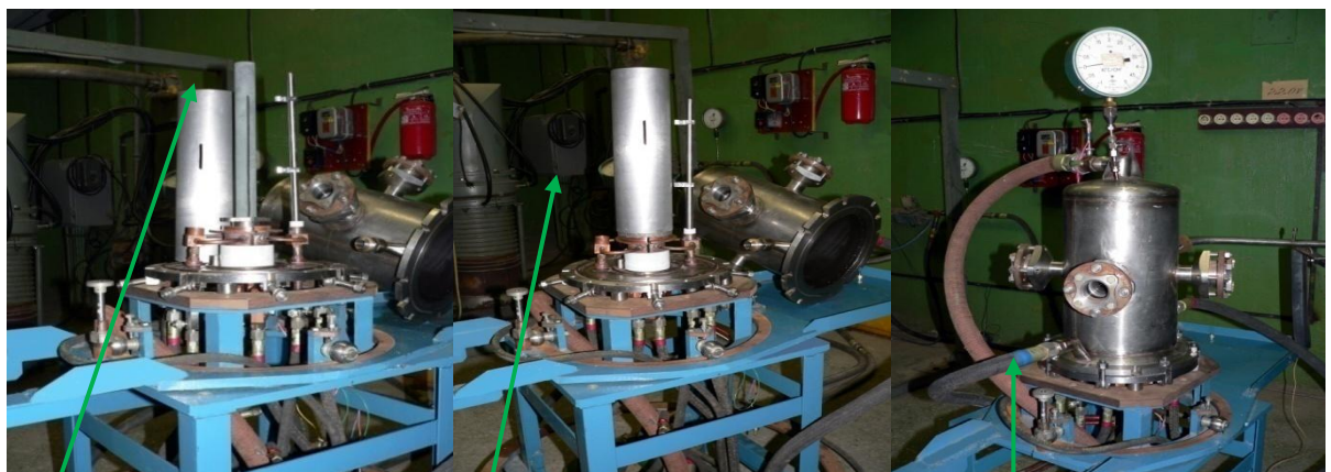
Нагреватель из УУКМ с прорезью
