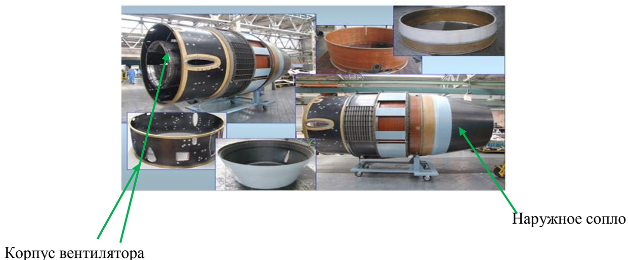
Рис. 1. Применение композитов в конструкции двигателей семейства ПС-90 А, изготовитель ОАО «Авиадвигатель», г. Пермь
