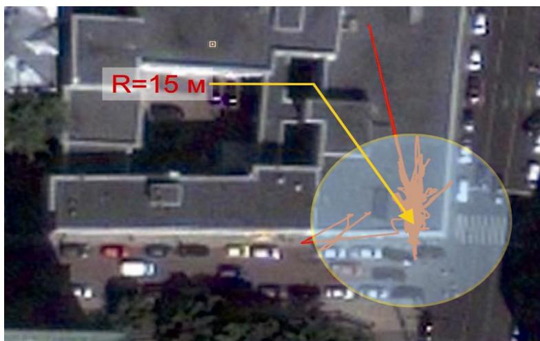
Рис. 1. Графическое представление распределения погрешности определения местоположения абонентской аппаратуры
