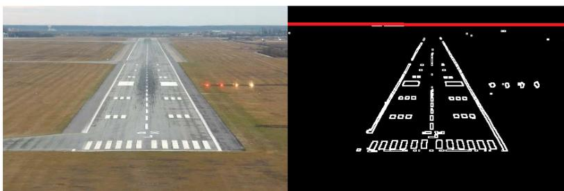
Рис. 4. Определение линии горизонта
