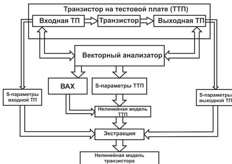
Рис. 1. Обобщенная процедура экстракции параметров мощного СВЧ транзистора
