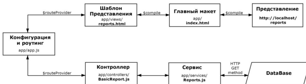
Рис. 3. Общая структура взаимодействия компонентов MVC в AngularJS
