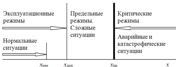
Рис. 1. Связь областей режимов полета и особых ситуаций со значениями определяющего параметра Fig. 1. Relationship between flight regime domains, special situations, and the values of the governing parameter
