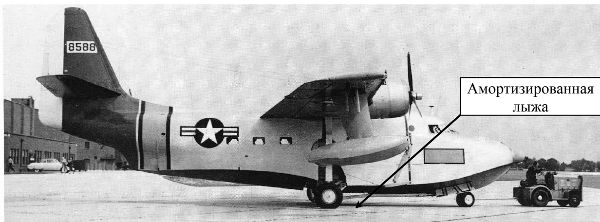
Рис.1. Grumman HU-16 Albatross, оборудованный амортизированными лыжами на днище корпуса и на подкрыльевых поплавках
