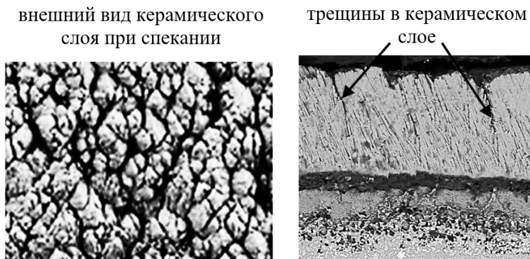
Рис. 2. Внешний вид керамического слоя ZrO_2 + 8\%Y_2O_3 в месте спекания и при появлении трещин Fig. 2. Appearance of the ceramic layer ZrO_2 + 8\%Y_2O_3 at the sintering site and when cracks appear
