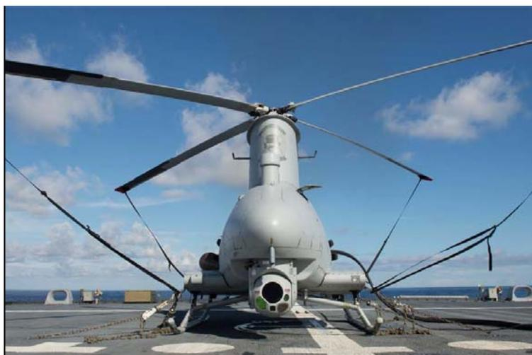
**Рис. 1.** БЛА ВТ MQ-8B Fire Scout
