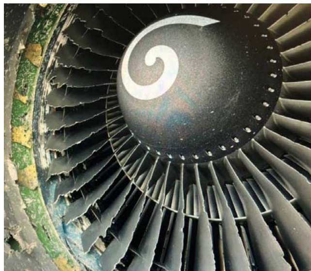
Рис. 2. Разрушенный двигатель в результате столкновения с птицей Fig. 2. Destroyed engine as a result of a bird strike
