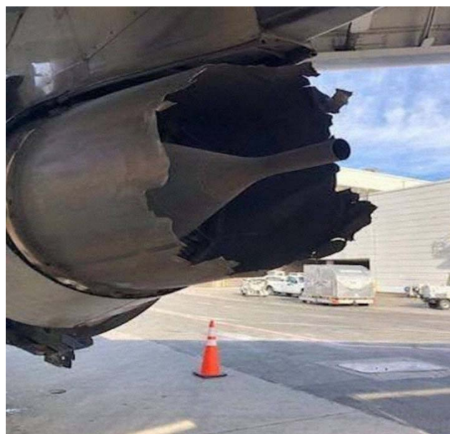
Рис. 3. Разрушенное сопло двигателя в результате столкновения с птицей Fig. 3. Destroyed engine nozzle because of a bird strike
