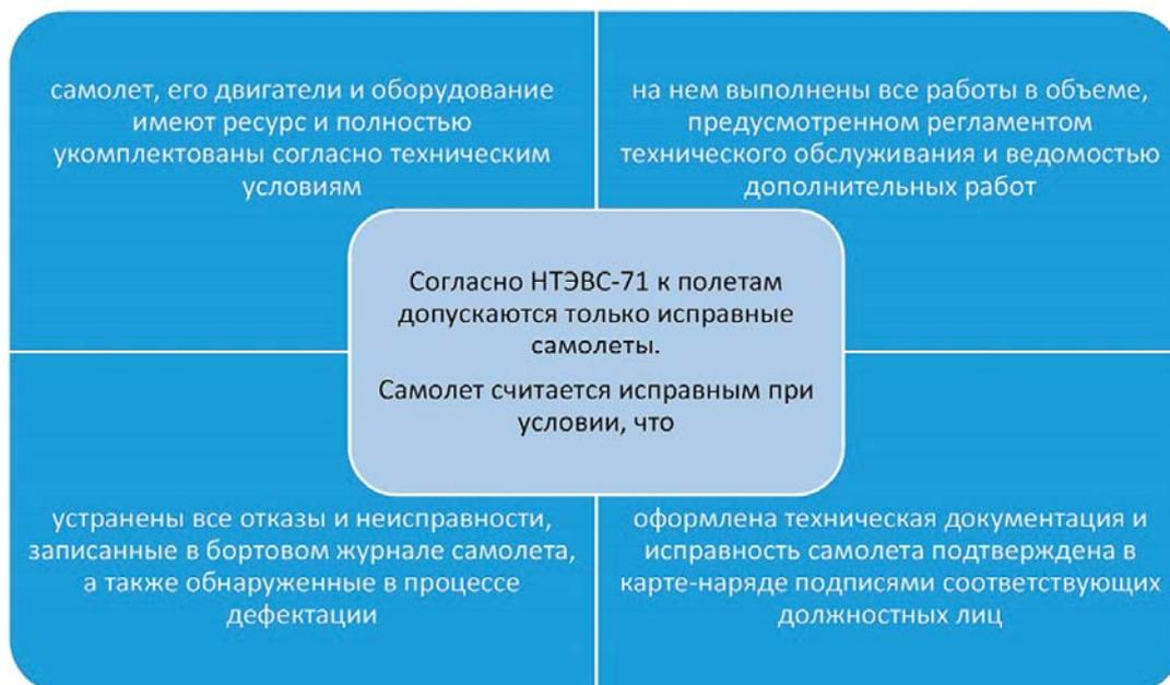
**Рис. 12.** Условия допуска самолета к полетам по НТЭВС ГА-71
