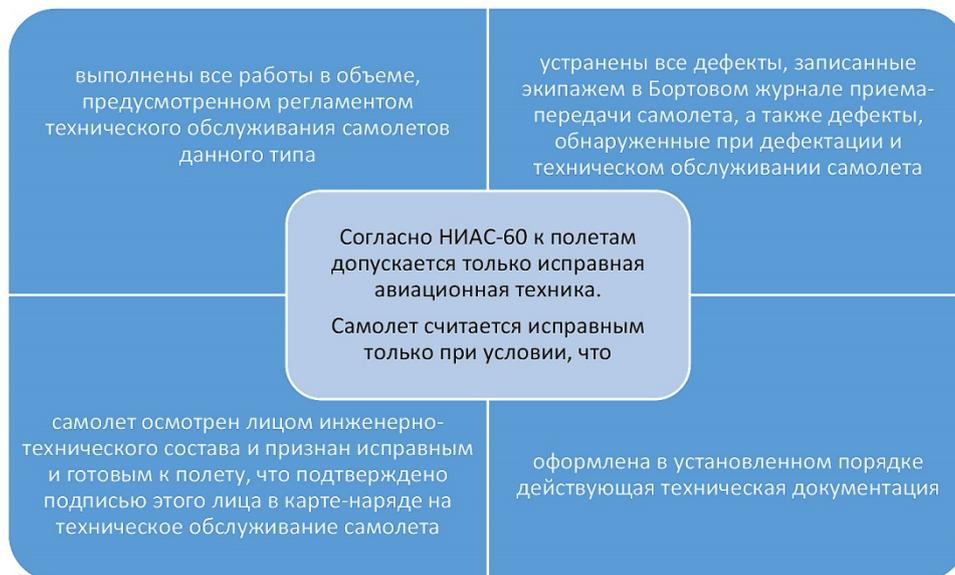
**Рис. 8.** Условия допуска самолета к полетам по НИАС ГА-60
